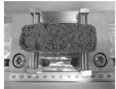
図 2 三点曲げ試験の様子
