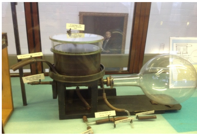
真空放電の装置 (初めて作られた自作機)
