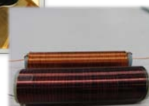
また学校にあるアクリルパイプとエナメル線を kullanarak 二種類のコイルを作成した。
