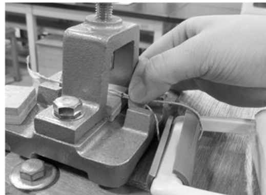
写真 3 印を合わせてハンディスケールの取っ手にくぐらせ固定する様子
