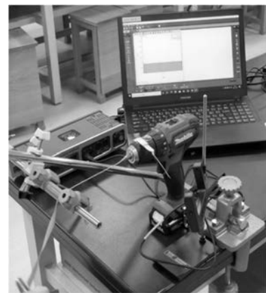
写真1 フォトゲートと電動ドリル
